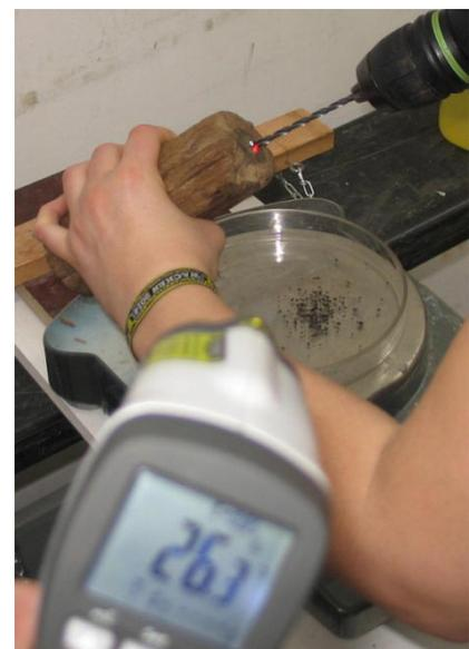
Abb. 11: Probenentnahme mittels Handbohrmaschine bei gleichzeitiger Temperaturmessung
