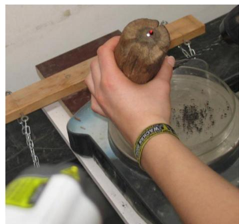
Abb. 12: Messung der Temperatur im Bohrloch mittels IR-Messgerät
