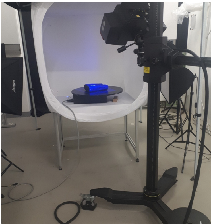
Abb. 11: ATOS III Rev. 02 mit 3D-Triple-Scan Technologie bei der Erfassung eines Probenkörpers am i3mainz, Institut für Raumbezogene Informations- und Messtechnik, Hochschule Mainz. C. Meyer, 2019
